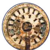
Gocciolatore occluso dalle precipitazioni formate durante l'utilizzo di acque dure.
